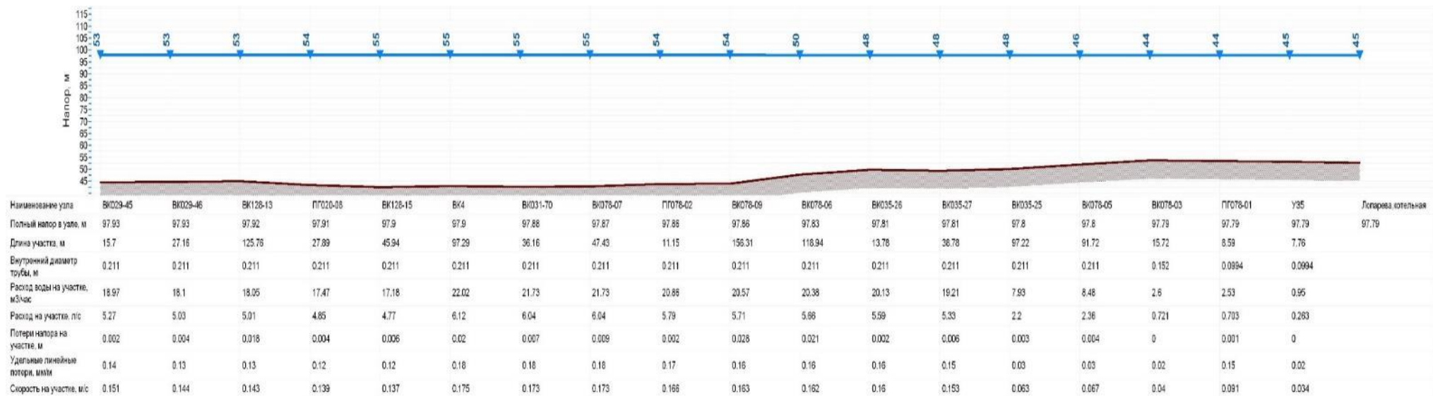
Пьезометрический график 1. Режим максимально-часового водопотребления (нормальный режим работы) сети по ул. Лопарева от ВК 029-45 до ПГ 078-01.
