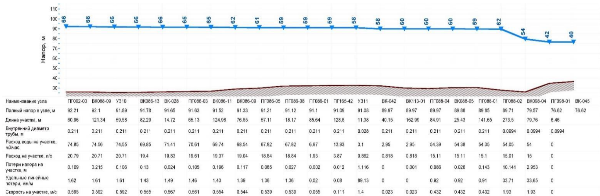
Пьезометрический график 8. Режим максимально часового водопотребления + пожар (случай пожаротушения), сеть по ул. Набережная от ПГ 092-03 до ПГ 098-01.
